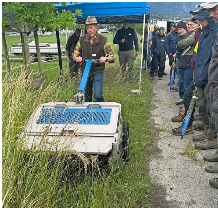
Das elektrobetriebene Gerät E-Beetle zur Saatgutgewinnung in Qualitätsflächen im Einsatz. BILD: ANDREA ACCOLA
